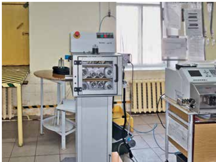
Участок жгутов аккумуляторно-стартерной группы. Размотчик кабеля Komax ads 112 (слева), установка нарезки и зачистки Komax Kappa 235 (справа)
