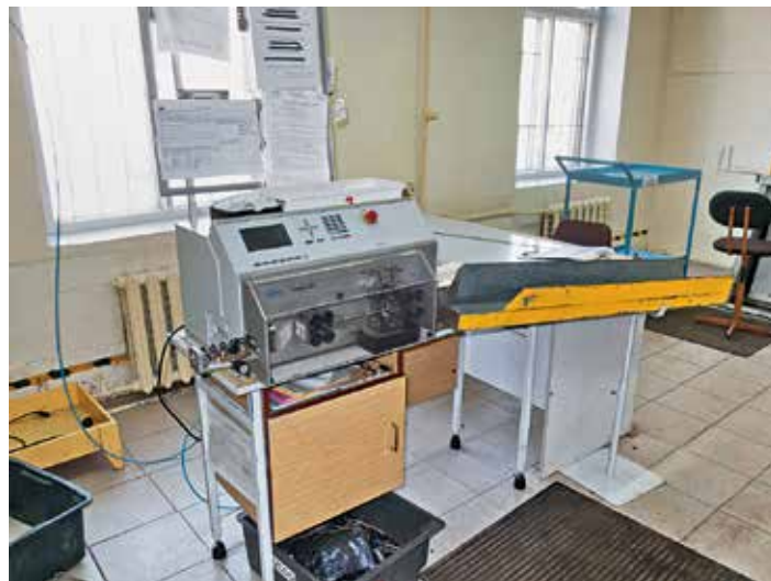
Участок жгутов аккумуляторно-стартерной группы. Размотчик кабеля Komax ads 112 (слева), установка нарезки и зачистки Komax Kappa 235 (справа)
