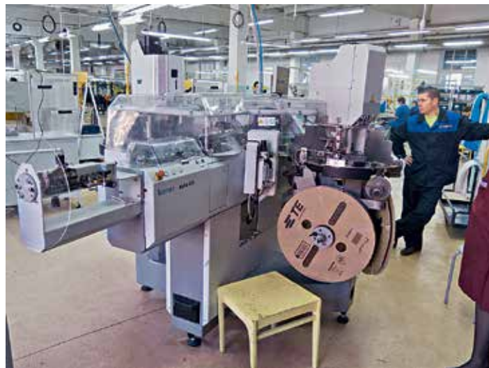
Автоматическая линия Комах Gamma 333 PC (слева). Автоматическая линия Комах Alpha 455 (справа). На переднем плане виден поворотный стол с аппликаторами
