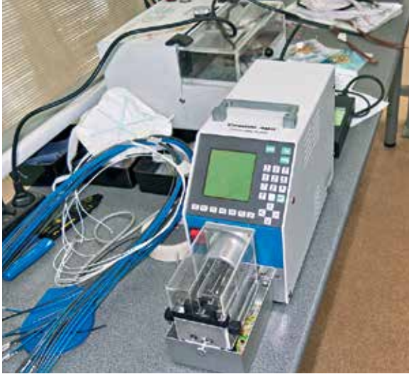
Полуавтомат Cosmic 48R компании Komax для зачистки тонких коаксиальных проводов (слева). Участок финишной сборки автомобильных жгутов (справа)
