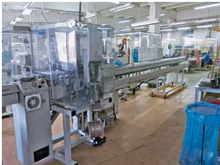
Автоматическая линия Комах Gamma 333 PC (слева). Автоматическая линия Комах Alpha 455 (справа). На переднем плане виден поворотный стол с аппликаторами
