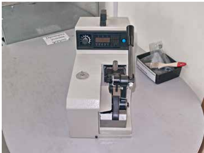
Установка для проверки усилия на отрыв Mecal SMST (слева). Стенд проверки геометрии жгута аккумуляторно-стартерной группы (справа)
