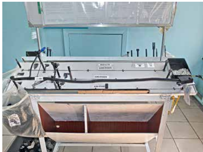
Установка для проверки усилия на отрыв Mecal SMST (слева). Стенд проверки геометрии жгута аккумуляторно-стартерной группы (справа)
